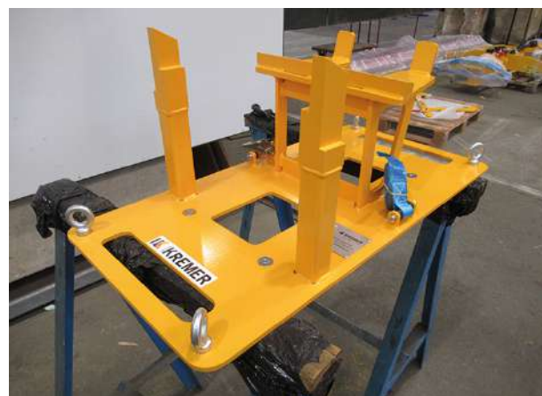
GK43295 - OUTILLAGE DE POSE ET DE DÉPOSE POUR ÉTRIER DE FREIN PORTEUR
