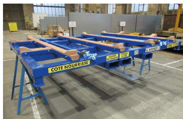
GK39635 - SUPPORT POUR LE TRANSPORT ET LE STOCKAGE DE LA TOITURE
