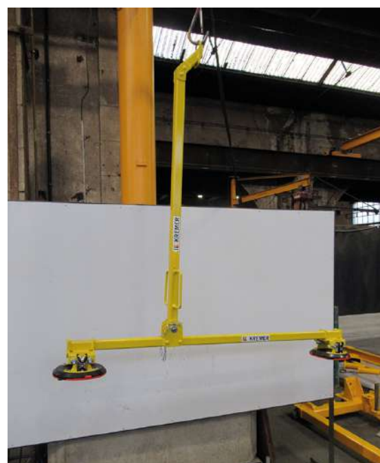
GK47778 - OUTIL DE POSE ET DE DÉPOSE DES VANTAUX
