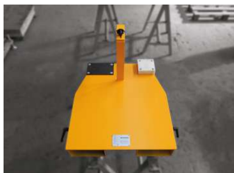
GK32225 - OUTILLAGE DE DÉPOSE DES PANNEAUX DE FREIN
