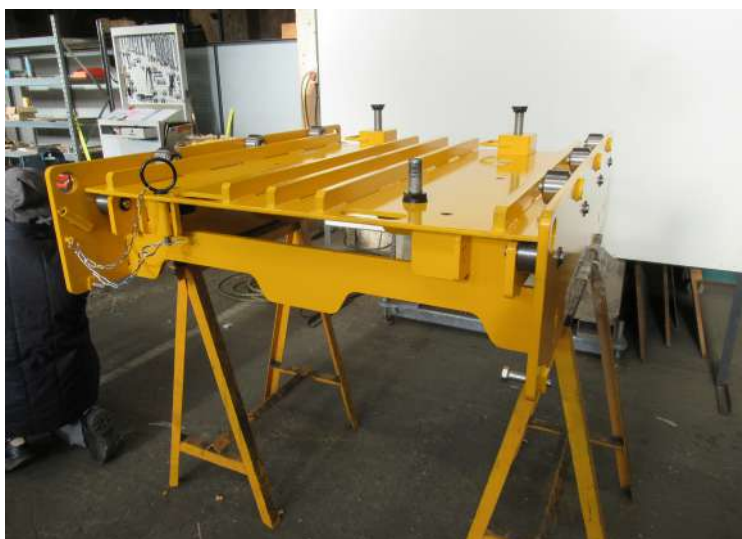
GK48079 - OUTILLAGE DE POSE DÉPOSE ESSIEUX MOTEUR
