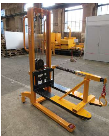
GK41363 - OUTILLAGE DE POSE DÉPOSE DU TURBO
