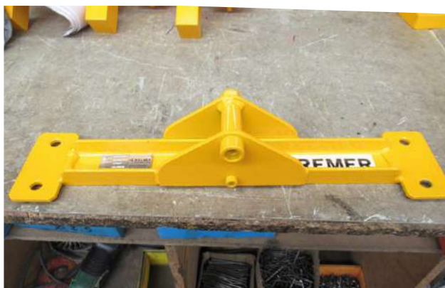
GK47307 - PALONNIER DE LEVAGE POUR BLOC RÉFRIGÉRANT
