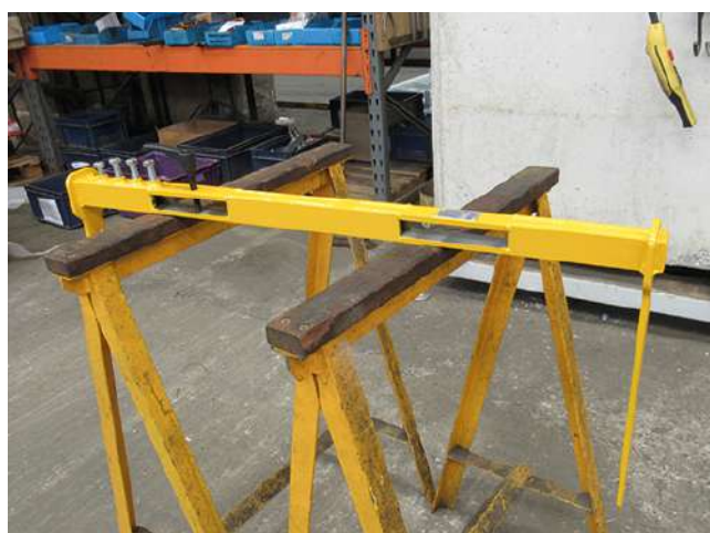
GK39635 - SUPPORT POUR LE TRANSPORT ET LE STOCKAGE DE LA TOITURE
