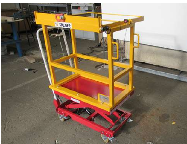
GK46626 - TABLE ÉLÉVATRICE POUR DÉPOSE DU VTBC
