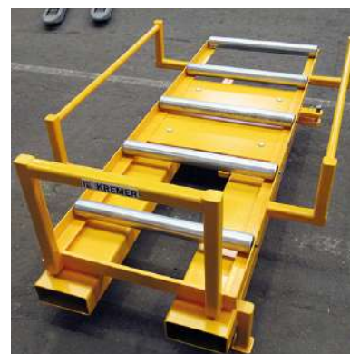
GK44174 - OUTILLAGE POSE DÉPOSE BANQUETTES
