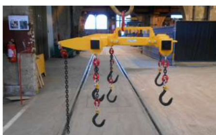
GK31892 - PALONNIER DE LEVAGE POUR POSE ET DÉPOSE DE COUPLEUR ÉLECTRIQUE
