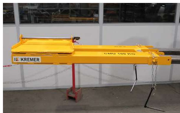
GK47282 - OUTILLAGE DE POSE ET DE DÉPOSE POUR BLOC FREIN
