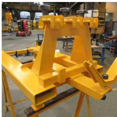
GK37883 - OUTILLAGE POSE DÉPOSE TAMPON
