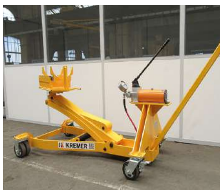
GK40600 - OUTILLAGE POSE DÉPOSE TAMPON
