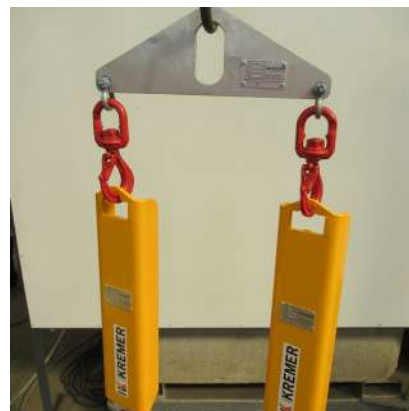
GK41191 - AGRAPHE ET PALONNIER DE COMPRESSION RESSORT BOGIE
